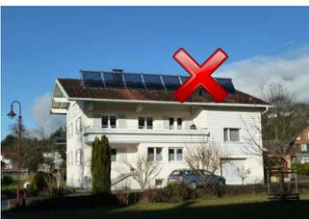
**2.3** Kollektoren haben die gleiche Orientierung und Neigung aufzuweisen wie Dachkanten und Dachflächen.
