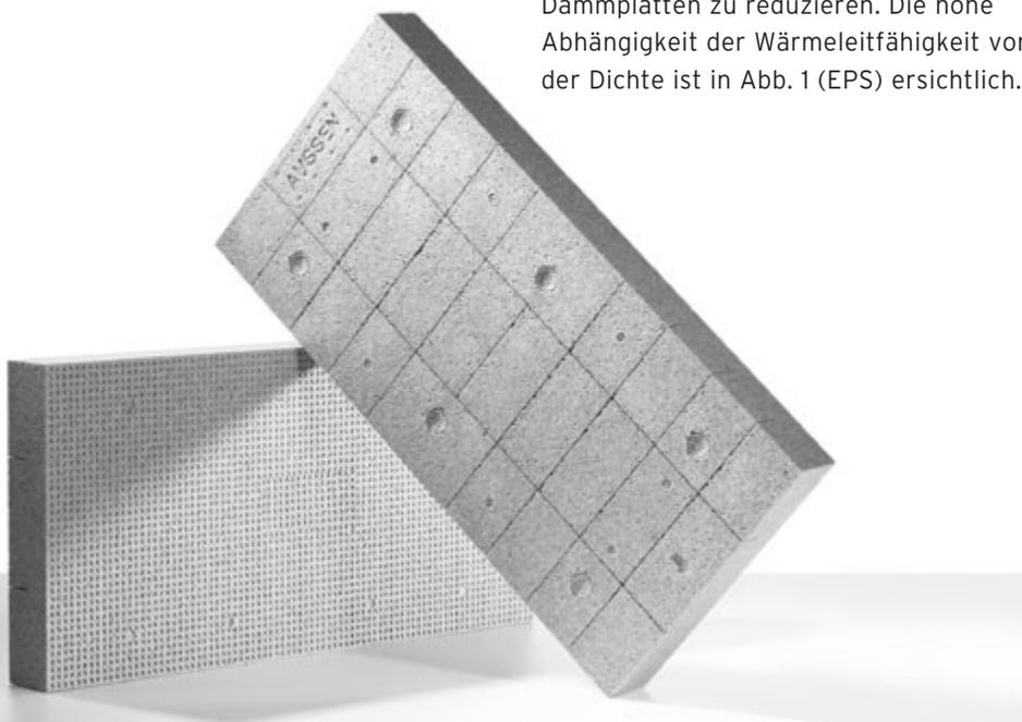
Formgeschäumte Platten sind etwas teurer in der Produktion, bieten dafür eine hohe Maßgenauigkeit und werden vor allem im Fassadenbereich gerne eingesetzt. Polystyrol Dämmstoffplatten unterliegen einem Schrumpfungsprozess von rund 2 Promille. Der Hauptschrumpfungsprozess vollzieht sich innerhalb der ersten 24 Stunden. Fassadendämmplatten werden vor der Verarbeitung aus diesem Grund rund drei Monate gelagert.
