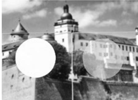
Abb. 3: Schalten eines Faser- bzw. Pulversystems von dem lichtstreuenden in den transparenten Zustand durch Einbringung einer Flüssigkeit.
